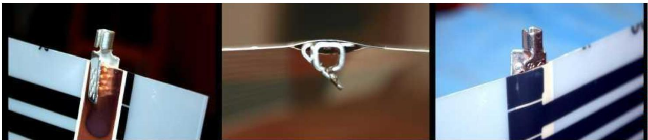
02. Inserarea conectorului argintiu între folie și banda de cupru - vedere din față
